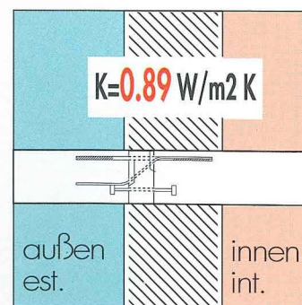
Mit Schöck Isokorb-Balkondämmelementen werden Balkonplatten optimal gedämmt. Tauwasser bildet sich nicht! Il balcone isolato con elementi Schöck Isokorb K8. Non si forma la condensa. Schöck Isokorb è l'isolamento ottimale.
